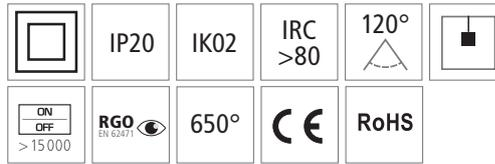
Ligne lumineuse en aluminium anodisé gris de 40 mm de large, d'une durée de vie de 50 000h L70B50 avec alimentation intégrée, disponible en version standard ou DALI. Disponible en 970 ou 1980 mm.
